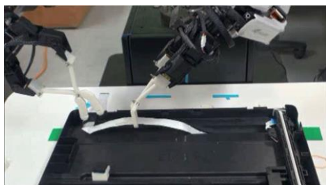
Fig.1 双腕ロボットによる電化製品のFCC配線自動化
